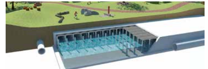
EEN VOORBEELD VAN EEN ONDERGRONDSE RIOOLWATERBERGINGSKELDER
